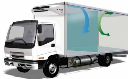
Mithilfe des brandneuen TSR-2-Reglers (Truck Smart Reefer 2) und der neuesten Regelsoftware kann der Benutzer eines Spectrum-Geräts der T-Serie eine Reihe programmierbarer Funktionen auswählen, um die Geräteleistung genau an die beförderte Ladung anzupassen. Dabei werden Temperaturregelung und Kraftstoffeffizienz aufeinander abgestimmt.
